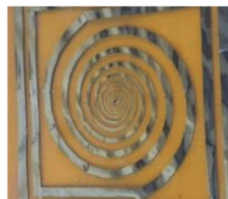
Element de RFID (antena si retea de atenuare simetrica)
