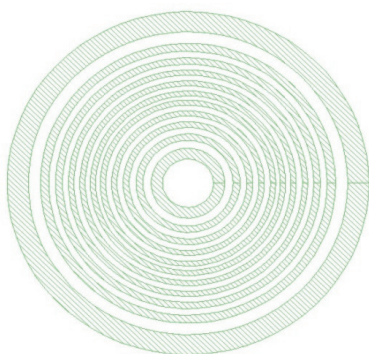
Configurația mastii fotolitografice necesare etapei a doua de corodare proiectate in softul CLEWIN.
