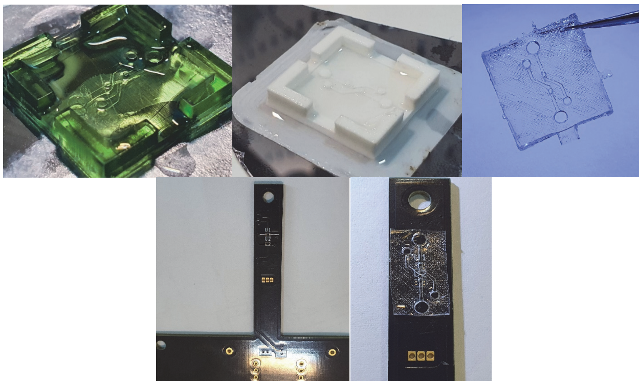
Figura 6.3.1.1. Succesiune etape tehnologice de obținere și asamblare sistem microfluidic cu senzori integrați pe o platformă PCB
