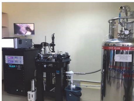
Echipament Criogenic pentru masurarea caracteristicilor d.c. si de microunde, in camp magnetic (2,5T), pana la 2 grade Kelvin
