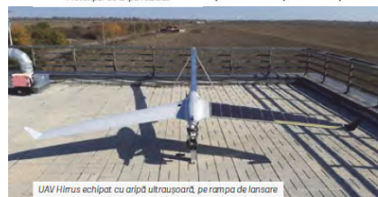
UAV Himus echipat cu arpa ultrașpură, pe rampa de lansare
