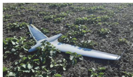
UAV Hirrus cu aripă cu arie de celule solare aterizat (îmbunătățire durată de zbor cu 20 min.)
