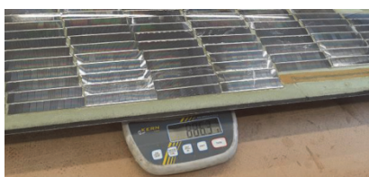
Aripă ultra ușoară cu arie de celule solare încorporată
